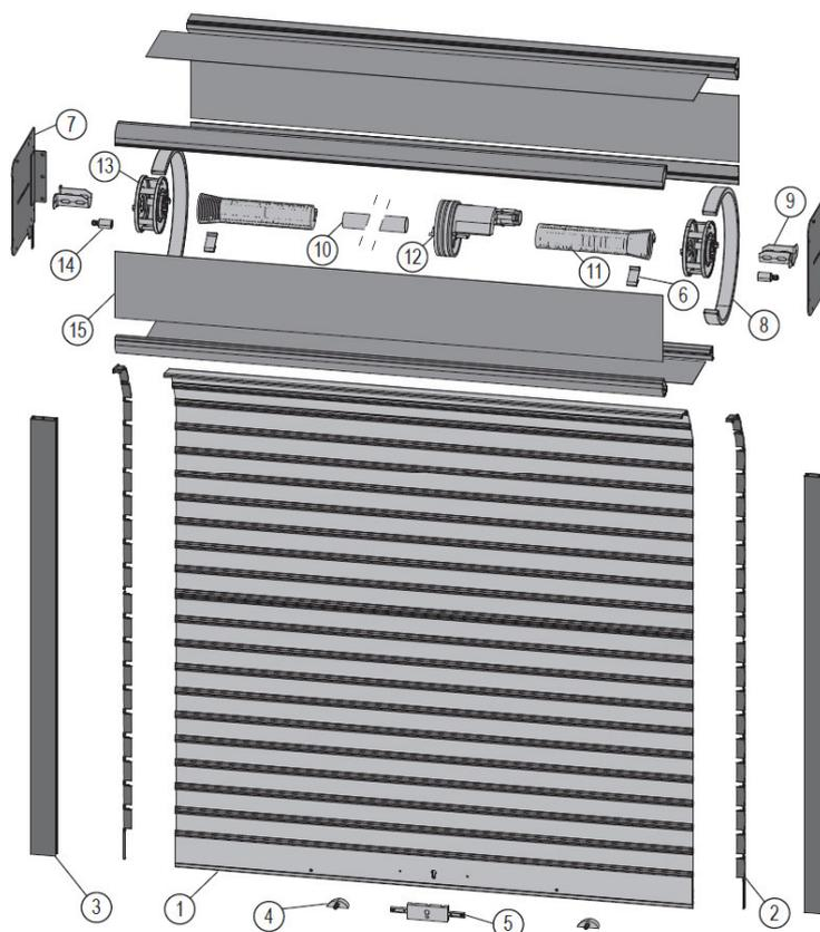
En la imagen aparecen la totalidad de los componentes que la puerta puede llevar instalados.
