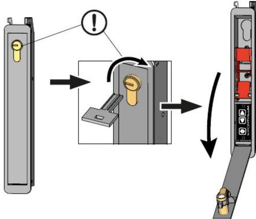
Tirar de la palanca roja, hasta que se quede fija con una pequeña inclinación
