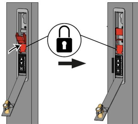
Para volver a bloquear el motor, tirar un poco de la palanca roja y pulsar al mismo tiempo la leva que está en la parte inferior de la palanca, llevando está a su sitio. El motor en este momento ya está operativo.
