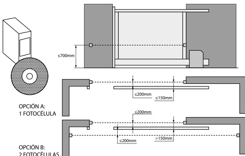
INSTALACIÓN DE FOTOCÉLULAS Y BANDA SENSIBLE PARA EL USO EN AUTOMÁTICO
